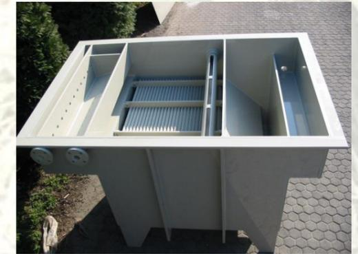
Unità di pretrattamento per rottura emulsioni e disoleazione lamellare.
